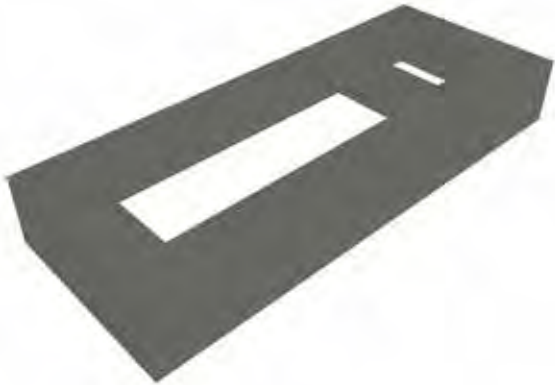
Fig 51 : socle CCV pour armoire de rue passive 1x15U outdoor
